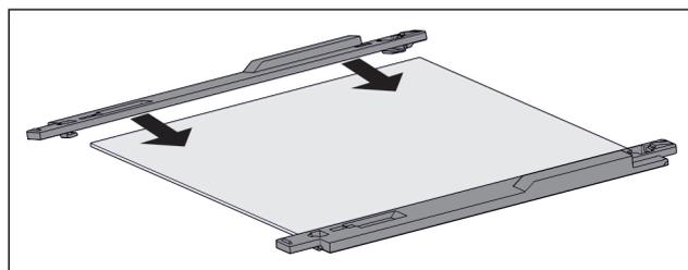
Fig. 108 Tablette en verre avec pièces de retenue
