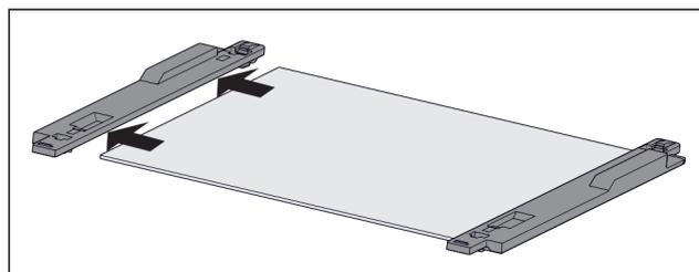
Fig. 107 Tablette en verre avec pièces de retenue
