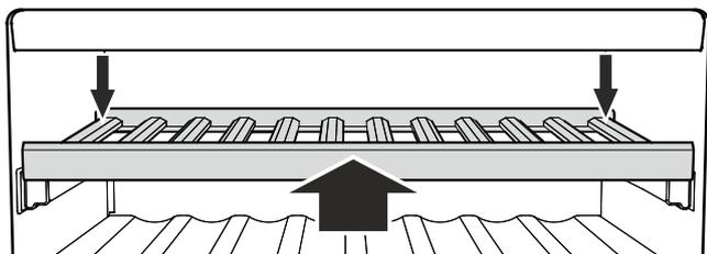
Presionar totalmente hacia atrás la balda de madera, a fin de que se enclave delante.
