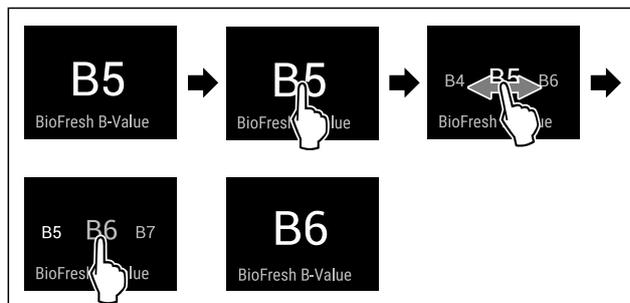
Fig. 21 Representación a modo de ejemplo: Cambiar de B5 a B6.
