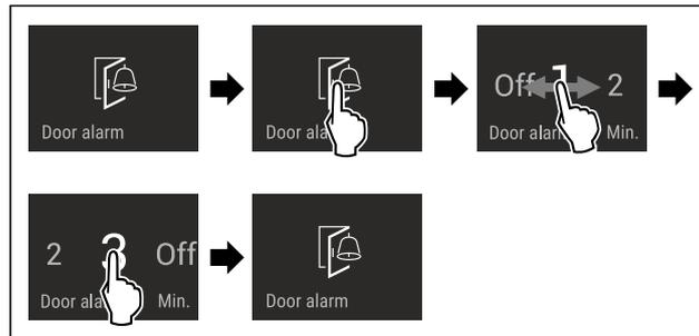
Fig. 39 Representación a modo de ejemplo: Cambiar alarma de puerta de 1 minuto a 3 minutos.
