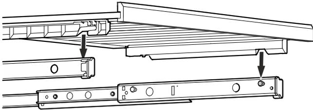
Sacar por completo las guías extraíbles. Colocar la balda de madera con las escotaduras delanteras sobre los pernos de soporte.
