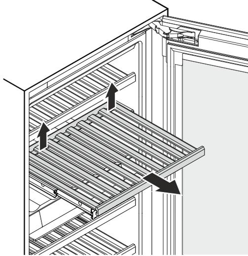
Tirar hacia arriba de la parte posterior derecha e izquierda de la balda de madera (desenclavar) y retirarla hacia delante.
