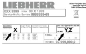
La classe climatica [Y] ovvero la classe di temperatura [Z] definiscono le condizioni di base max per un corretto funzionamento degli apparecchi.
