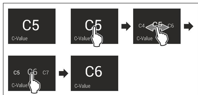
Fig. 22 Beispielhafte Darstellung: Von C5 zu C6 wechseln.
