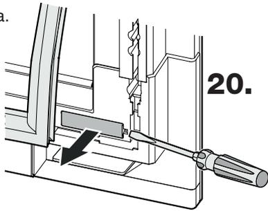
**21.** Smontare il dispositivo di sicurezza per il trasporto.
