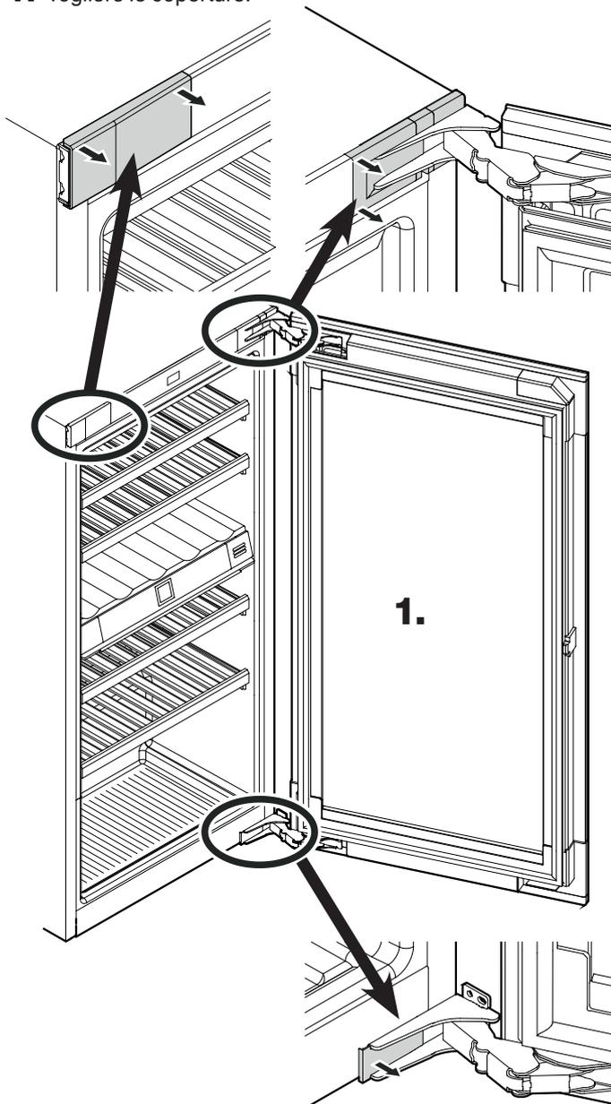
**2.** Smontare il dispositivo di sicurezza per il trasporto.
