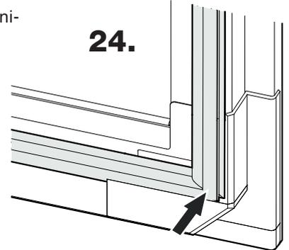
Controllare che l'apparecchio sia montato nel corpo del mobile in modo stabile e sicuro e che lo sportello si chiuda bene.
