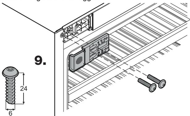
**10.** Avvitare l'angolare di fissaggio.
