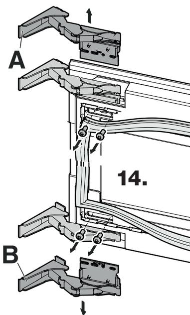
**15.** Svitare le piastre di fissaggio dalle cerniere e riavvitarle sulle altre cerniere una per volta (la piastra di fissaggio Top rimane in alto + la piastra di fissaggio Bottom rimane in basso). Riavvitare le cerniere nella posizione diagonale opposta dello sportello.
