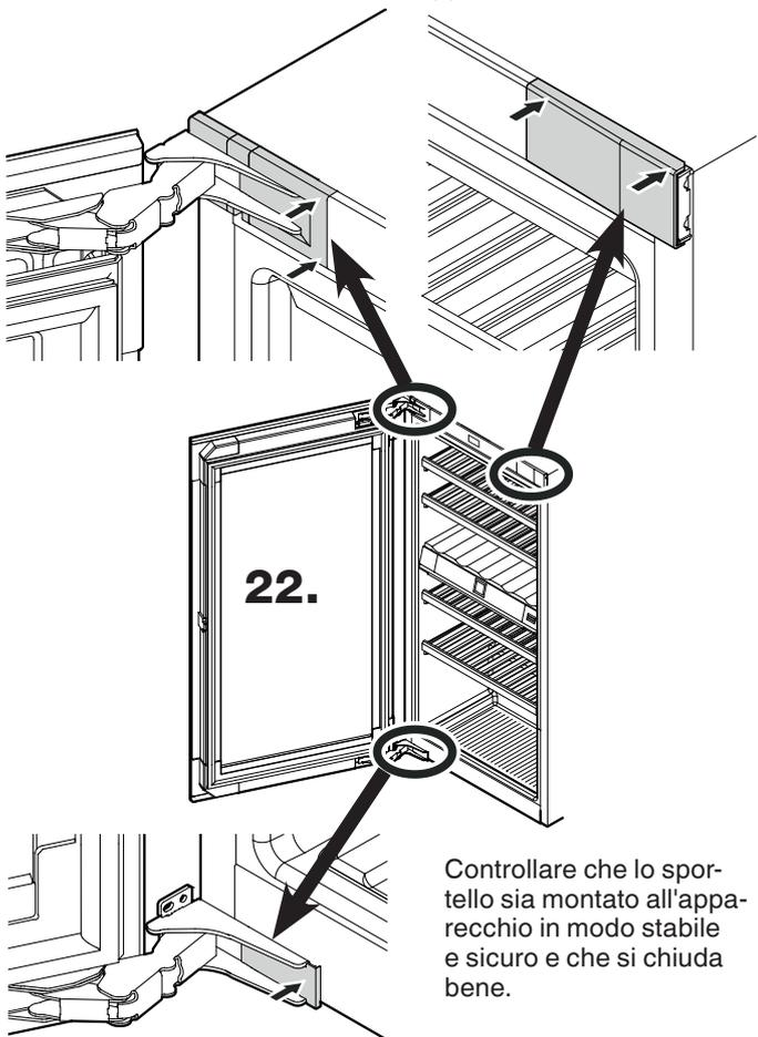
Controllare che lo sportello sia montato all'apparecchio in modo stabile e sicuro e che si chiuda bene.
