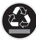
Ova ili slična naljepnica može se nalaziti na stražnjoj strani uređaja. Ona upućuje na to da se u vratima i/ili u kućištu nalaze vakuumске izolacijske ploče (VIP) ili perlite ploče. Ova napomena važna je samo radi recikliranja. Ne skidajte naljepnicu.
