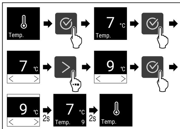
Fig. 95 Cambio de temperatura de 7 °C a 9 °C
