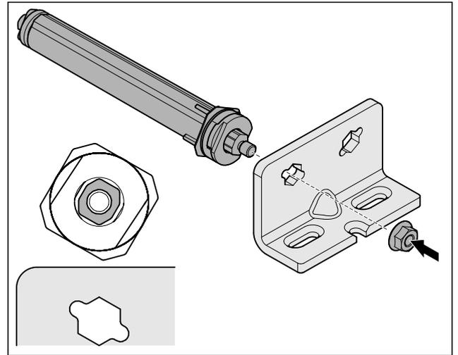
Fig. 31 Montaje de las bisagras a la izquierda
