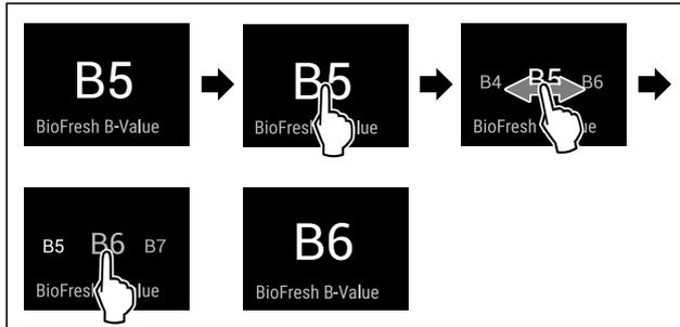
Fig. 23 Representación a modo de ejemplo: Cambiar de B5 a B6.
