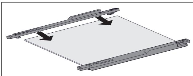
Fig. 129 Placa de vidrio con piezas de sujeción
