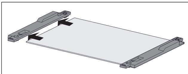
Fig. 128 Placa de vidrio con piezas de sujeción
