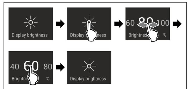
Fig. 61 Representación a modo de ejemplo: Cambiar de 80 % a 60 %.
