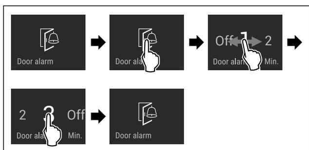
Fig. 64 Representación a modo de ejemplo: Cambiar alarma de puerta de 1 minuto a 3 minutos.
