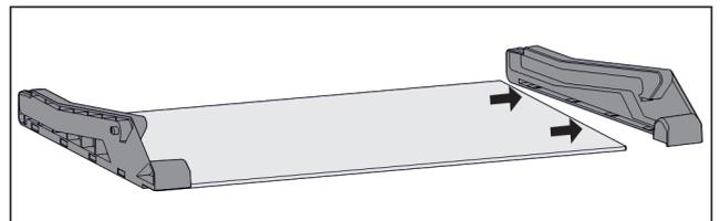
Fig. 121 Placa de vidrio con piezas laterales
