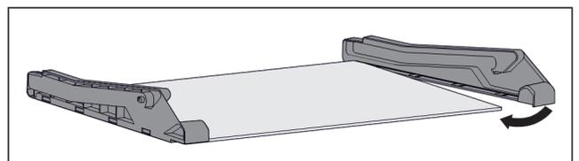
Fig. 122 Placa de vidrio con piezas laterales
