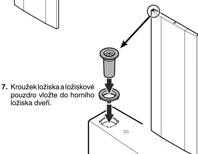
**7. Kroužek ložiska a ložiskové pouzdro vložte do horního ložiska dveří.**
