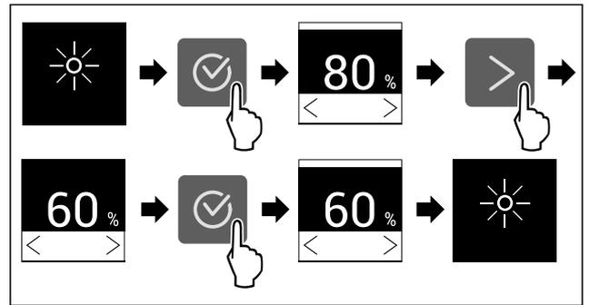
Fig. 56 Représentation à titre d'exemple : Passer de 80 à 60 %.
