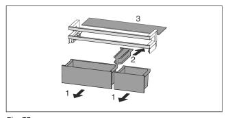
Fig. 33▶ Disassemble the door rack.
