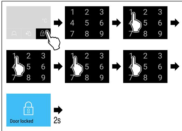
Fig. 72 Verrouiller la porte avec le code 1 1 1 1.
