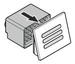
• Inserire il filtro, spingere a fondo fino all'arresto e rilasciare. Il filtro si blocca automaticamente.
