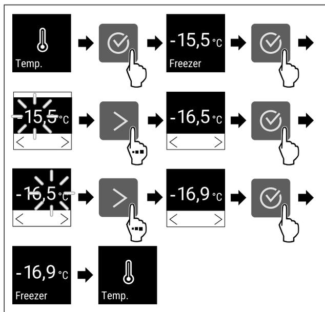
Fig. 68 Variazione di temperatura da -15,5 °C a -16,9 °C
