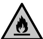
Symbol se nahaja na kompresorju in označuje nevarnost vnetljivih snovi. Nalepke ne odstranite.
