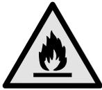
**ПРЕДУПРЕЖДЕНИЕ:** Опасность пожара / горючие материалы. Символ находится на компрессоре и обозначает опасность от пожароопасных веществ. Не удаляйте наклейку.
