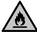
**AVERTISSEMENT** : Risque d'incendie / matériaux inflammables. Le symbole se trouve sur le compresseur et indique le danger lié à la présence de substances inflammables. Ne pas enlever l'autocollant.
