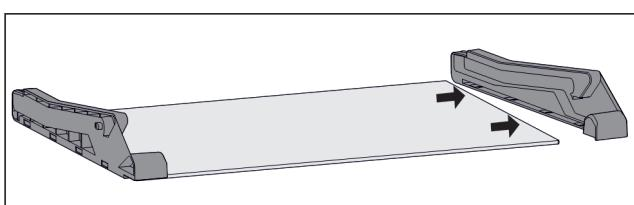
Fig. 53 Steklena plošča s stranski deli
