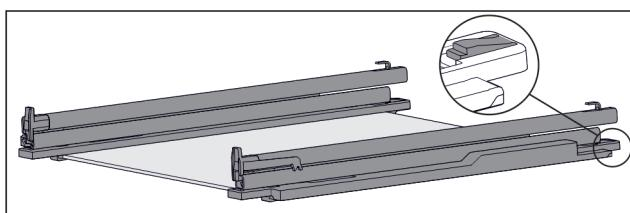
Fig. 58 Steklena plošča z vodili in držalnimi deli
