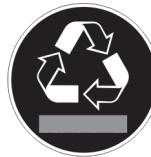
Takšno ali podobno nalepko boste lahko našli na zadnji strani naprave. Opozarja na to, da so v vratih in/ali v ohišju vakuumski izolacijski paneli (VIP) ali perlitovi paneli. Ta napotek je pomemben samo za recikliranje. Nalepke ne odstranite.
