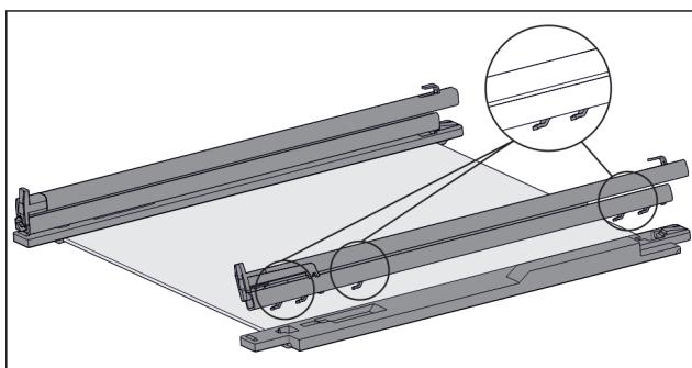
Fig. 59 Steklena plošča z vodili in držalnimi deli
