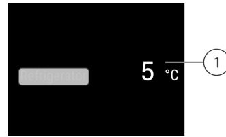
Fig. 6 Afișajul de status arată temperatura reală.
