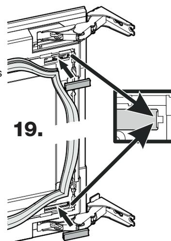
**20.** Mettre en place le joint d'étanchéité.
