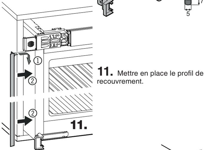
**11.** Mettre en place le profil de recouvrement.
