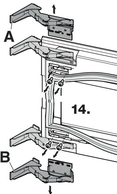
**15.** Dévisser les plaques de fixation des charnières et les revisser sur les autres charnières respectives (la plaque de fixation supérieure "Top" reste en haut et la plaque de fixation inférieure "Bottom" reste en bas). Revisser les charnières en diagonale aux positions opposées de la porte.
