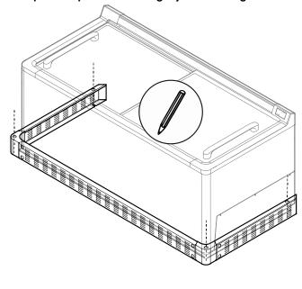
3. Percer les trous et monter les goujons d'ancrage.
