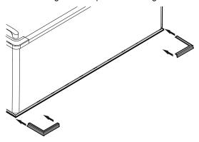
Enfoncer et introduire la baguette de protection dans les baguettes profilées sur les côtés et à l'avant.
