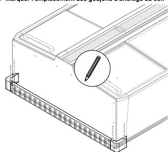
3. Percer les trous et monter les goujons d'ancrage.
