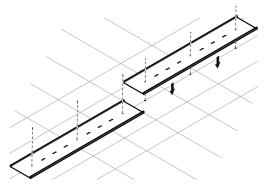
Positionner les appareils de façon à ce que les pieds arrières touchent les rails d'assemblage.
