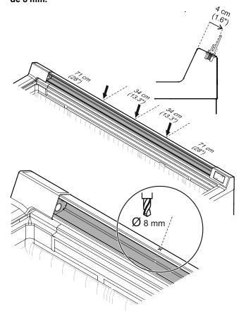
3. Placer les pièces de support dans les trous de perçage et les fixer avec les écrous à ailettes.
