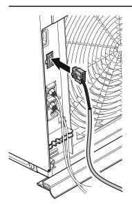
5. Brancher le connecteur du câble d'alimentation électrique.
