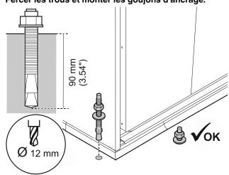
4. Monter les pièces assemblées sur les goujons d'ancrage et serrer les écrous.
