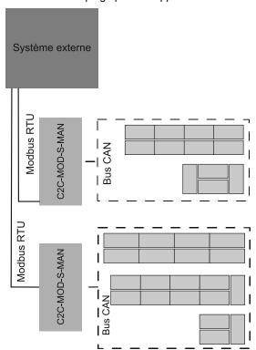
Pour la connexion des appareils entre eux, chaque appareil dispose de deux prises bus CAN, voir « Connexion des câbles », page 10.
