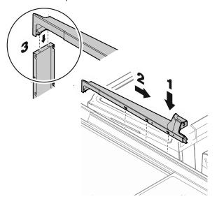
Installer la pièce de jonction droite en l'insérant dans la pièce de jonction gauche, puis l'accrocher aux boulons de fixation, faire glisser vers la gauche et pousser les tenons dans les parties latérales.
