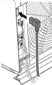
6. Monter la décharge de traction tout en tenant les câbles. Insérer la vis.
