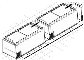
Positionner les appareil de la rangée opposée de la même façon. Veiller à ce que les appareils soient disposés parallèlement les uns aux autres.
