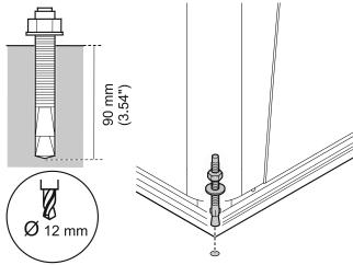
4. Monter les pièces assemblées sur les goujons d'ancrage et serrer les écrous.
