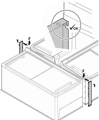
Insérer la pièce de jonction gauche et l'accrocher aux boulons de fixation, faire glisser vers la droite et pousser les tenons dans les parties latérales.
