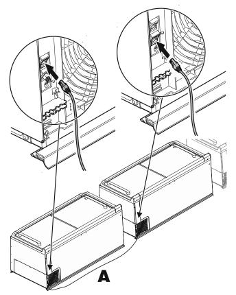
Afin de pouvoir connecter d'autres appareils, raccorder le connecteur d'un nouveau câble réseau (B) sur le deuxième appareil et le relier à l'appareil suivant. Renouveler l'opération jusqu'à ce que tous les appareils soient connectés.
