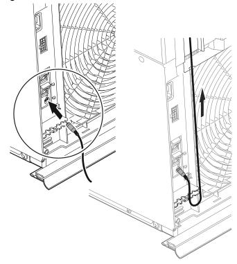
Faire passer l'interface de service par le bas via l'ouverture du boîtier du bandeau de commande puis l'insérer dans l'ouverture droite du boîtier.
