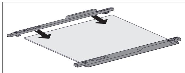
Fig. 128 Tablette en verre avec pièces de retenue
