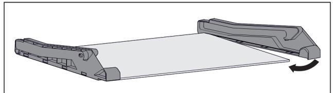
Fig. 81 Placa de vidrio con piezas laterales
