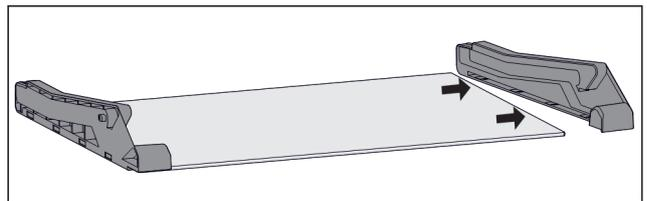
Fig. 80 Placa de vidrio con piezas laterales
