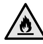
**ΠΡΟΕΙΔΟΠΟΙΗΣΗ:** Κίνδυνος πυρκαγιάς / εύφλεκτα υλικά. Το σύμβολο βρίσκεται στον συμπιεστή και επισημαίνει τον κίνδυνο από εύφλεκτα υλικά. Μην αφαιρείτε το αυτοκόλλητο.
