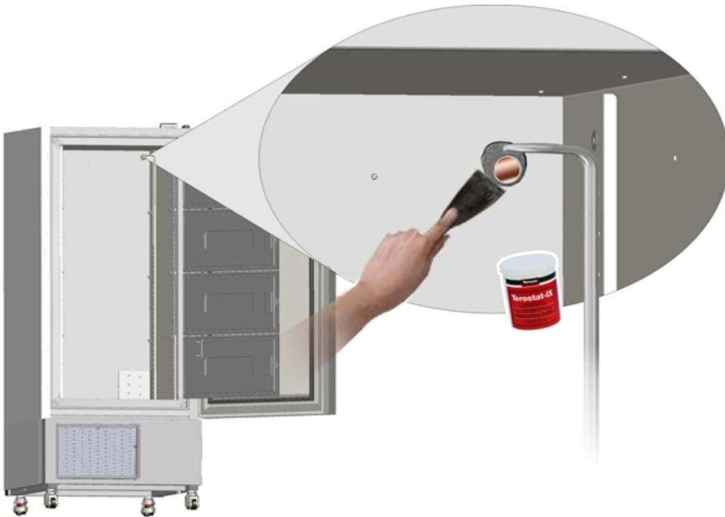
22. Isolieren Sie die im Notkühlungsgehäuse angebrachten Rohre und Silikonschläuche mit den beiliegenden passenden Armaflex-Schläuchen.
