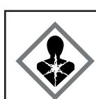
Символът може да бъде поставен върху компресора. Той се отнася за маслото в компресора и указава следната опасност: може да бъде смъртоносно при погълдане и проникване в дихателните пътища. Това указание се отнася само за процеса по рециклиране. По време на нормалната експлоатация не съществува опасност.
