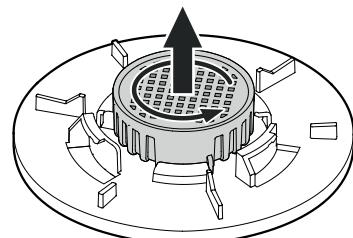
Τοποθετήστε νέο φίλτρο αέρα και στρέψτε δεξιόστροφα, έως ότου ασφαλίσει.
