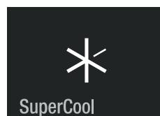
Για μέγιστη ψύξη με χρονικό περιορισμό και αυτόματη επιστροφή σε φυσιολογική λειτουργία.
