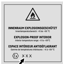
Fig. 3 Beskyttelsesklasse: II 3/-G Ex ec IIC T6 Gc/-
