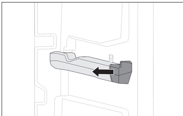
Fig. 141 Elemento inseribile sulla nervatura destra del contenitore
