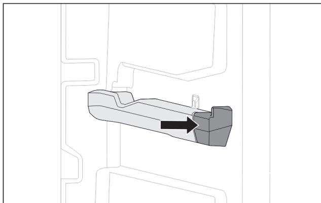
Fig. 143 Elemento inseribile sulla nervatura destra del contenitore
