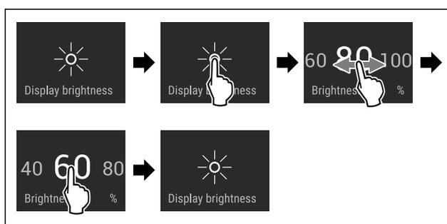
Fig. 46 Représentation à titre d'exemple : Passer de 80 à 60 %.
