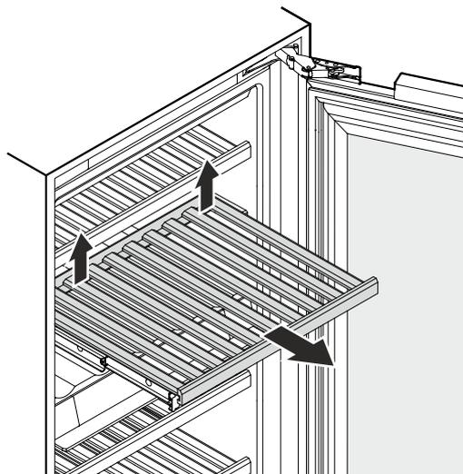
Soulever (désenclipser) la partie arrière de la clayette en bois à droite et à gauche et la retirer vers l'avant.
