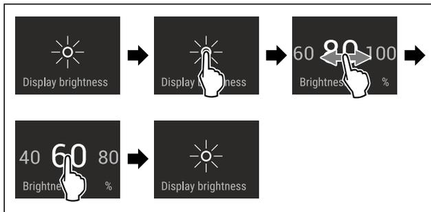
Fig. 35 Représentation à titre d'exemple : Passer de 80 à 60 %.
