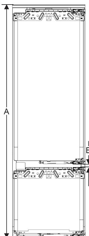
Fig. 65 Положение зазора двухдверного мебельного фасада
