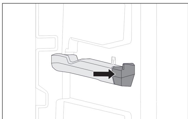
Fig. 109 右侧容器肋梁上的插装件
