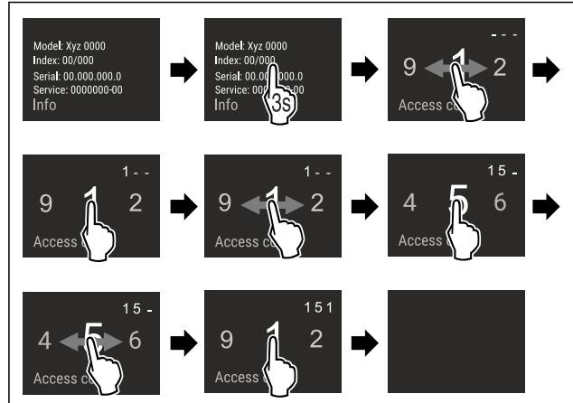
Fig. 4 例图，使用数字代码 151 访问
