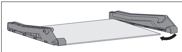
Fig. 111 带侧盖板的玻璃隔板
