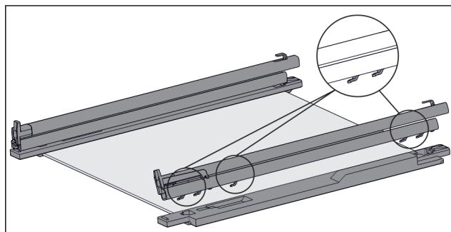
Fig. 116 带轨道和固定件的玻璃隔板
