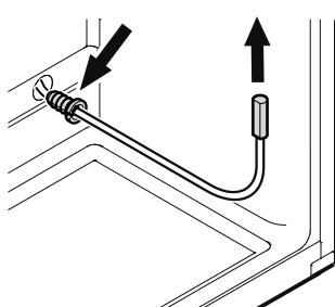
Περάστε τον αισθητήρα μέσα από το άνοιγμα και ασφαλίστε το καλώδιο αισθητήρα με ανακουφιστικό καταπόνησης.
