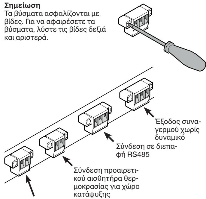
Σύνδεση προαιρετικού αισθητήρα θερμοκρασίας για χώρο κατάψυξης
