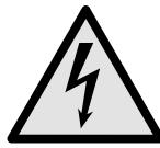
Simbolul este situat pe partea din spate a aparatului, în zona releului de alarmă, și indică următorul pericol: **Soc electric!** Chiar și atunci când aparatul este deconectat de la rețeaua electrică, tensiunea externă poate fi încă prezentă. Nu îndepărtați eticheta autocolantă.
