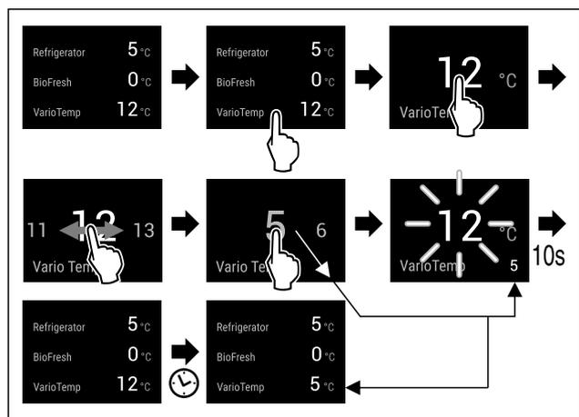
Fig. 32 Immagine a titolo di esempio: Far passare VarioTemp da 12 °C a 5 °C per una combinazione frigorifero-congelatore BioFresh.
