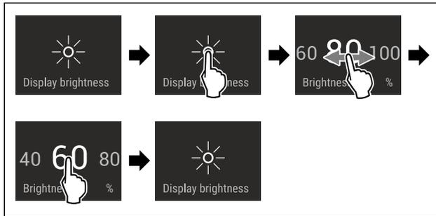
Fig. 37 Représentation à titre d'exemple : Passer de 80 à 60 %.
