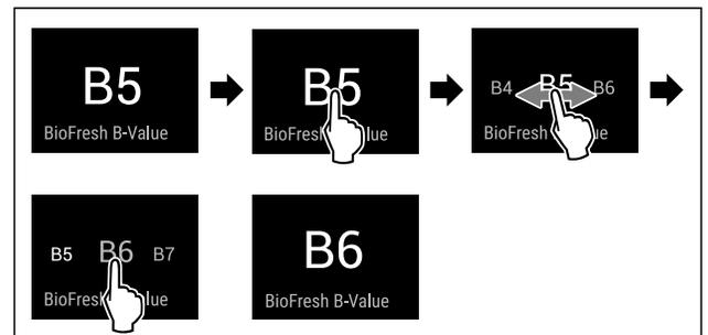
Fig. 21 Représentation à titre d'exemple : Passer de B5 à B6.
