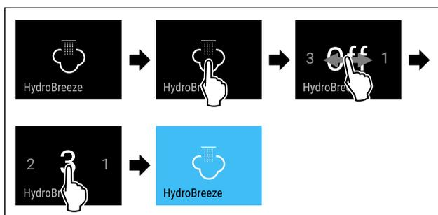
Fig. 30 Représentation à titre d'exemple : Activer HydroBreeze avec la valeur 3.
