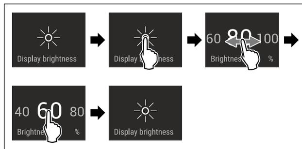
Fig. 50 Représentation à titre d'exemple : Passer de 80 à 60 %.
