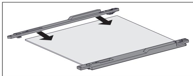
Fig. 99 Tablette en verre avec pièces de retenue
