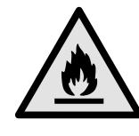
**UPOZORENJE:** Opasnost od požara / zapaljivi materijali. Simbol se nalazi na kompresoru i upozorava na opasnost od zapaljivih tvari. Ne skidajte naljepnicu.
