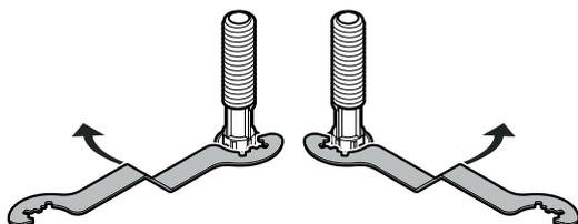
Girare la chiave in senso orario per sollevare l'apparecchio anteriormente e ruotare in senso antiorario per abbassarlo.
