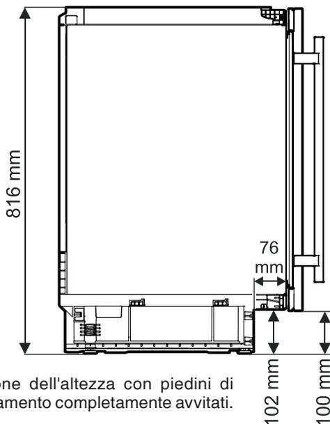
Indicazione dell'altezza con piedini di posizionamento completamente avvitati.
