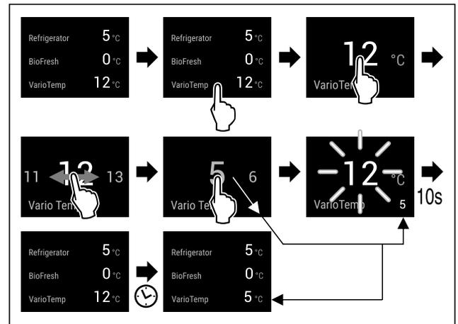
Fig. 36 Representación a modo de ejemplo: Cambiar el VarioTemp de 12 °C a 5 °C para una combinación frigorífico-congelador con BioFresh.\*
