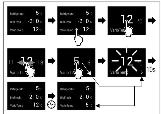
Fig. 37 Representación a modo de ejemplo: Cambiar el VarioTemp de 12 °C a 5 °C para una combinación frigorífico-congelador con cajón Fish & Seafood.\*
