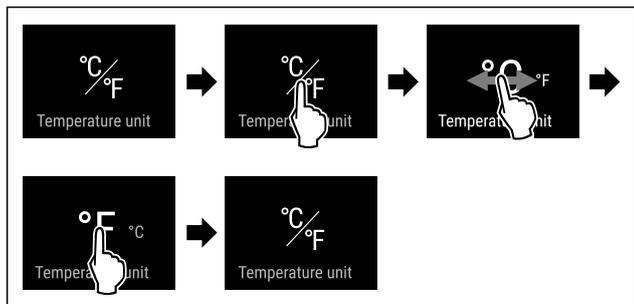
Fig. 27 Representación a modo de ejemplo: Cambiar de grados Celsius a Fahrenheit.
