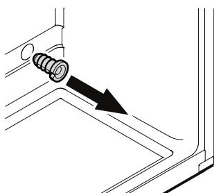
Снимите скобу для разгрузки от натяжения кабеля.
