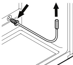
Просуньте датчик через отверстие и предохраните кабель датчика скобой для разгрузки от натяжения.
