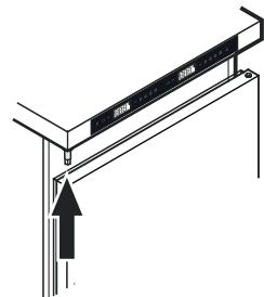
13. Поворачивайте пружинный механизм двери холодильной камеры вилочным гаечным ключом против часовой стрелки, пока шестигранник торсиона не войдет в зацепление в выемке среднего шарнирного уголка.
