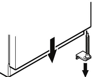
2. Снимите дверь морозильной камеры, потянув ее вниз.
