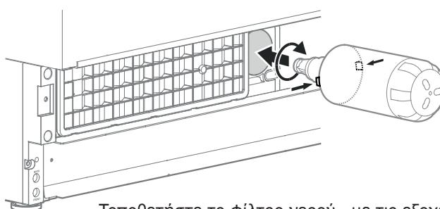
Τοποθετήστε το φίλτρο νερού - με τις εξοχές σε οριζόντια θέση - έως το σημείο αναστολής και στρέψτε δεξιόστροφα, έως ότου ασφαλίσει.
