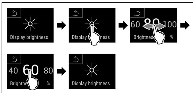
Fig. 105 Representación a modo de ejemplo: Cambiar de 80 % a 60 %.
