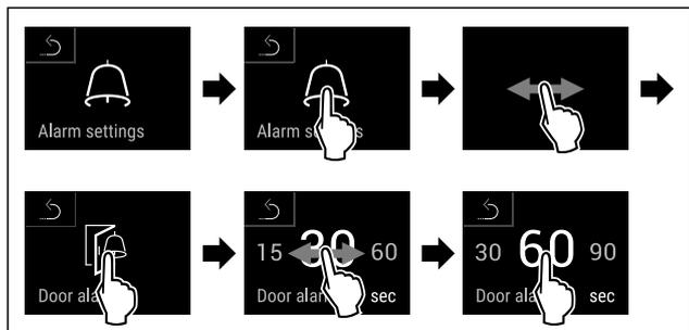
Fig. 163 Representación a modo de ejemplo: Cambiar alarma de puerta de 30 segundos a 60 segundos.
