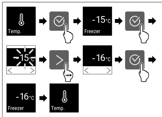
Fig. 68 Cambio de temperatura de -15 °C a -16 °C
