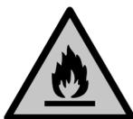
Il simbolo si trova nel compressore e segnala il pericolo di sostanze infiammabili. Non rimuovere l'adesivo.
