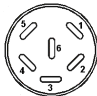
Figure 20: Affectation des pins de la douille (10) pour l'option sortie analogique
