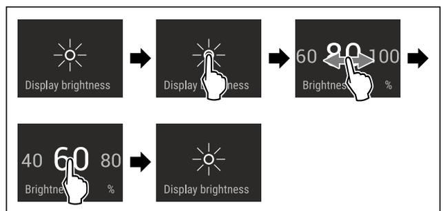
Fig. 32 Beispielhafte Darstellung: Von 80 % zu 60 % wechseln.
