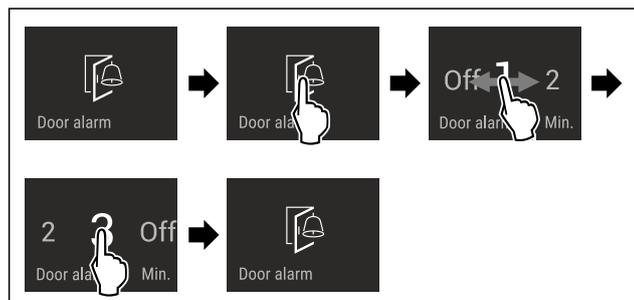
Fig. 34 Beispielhafte Darstellung: Türalarm von 1 Minute zu 3 Minuten wechseln.
