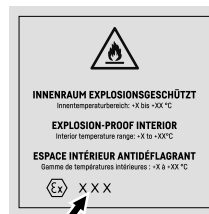
Fig. 3 Apsaugos klasė: II 3/-G Ex ec IIC T6 Gc/-
