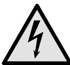
Simbol boste našli na hrbtni strani naprave na območju alarmnega releja in ponazarja na to nevarnost: **Električni udar!** Tudi če je prekinjeno električno napajanje naprave, je v napravi lahko še vedno prisotna napetost. Nalepke ne odstranite.
