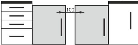
Wird dieser Abstand nicht eingehalten, so bildet sich Kondenswasser zwischen den Seitenwänden der Geräte.
