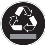
Dieser oder ein ähnlicher Aufkleber kann sich auf der Rückseite des Gerätes befinden. Er verweist darauf, dass sich in der Tür und/oder im Gehäuse Vakuumsisulierpaneele (VIP) oder Perlitpaneele befinden. Dieser Hinweis ist nur für das Recycling bedeutsam. Den Aufkleber nicht entfernen.
