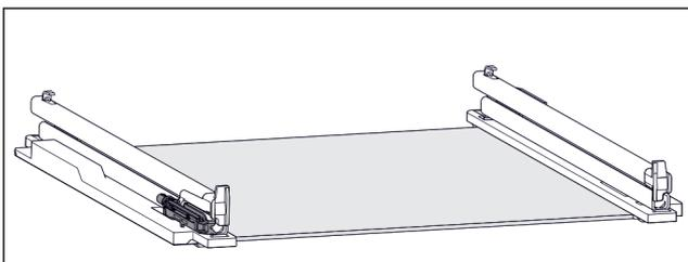
Fig. 130 Dämpfungseinheit
